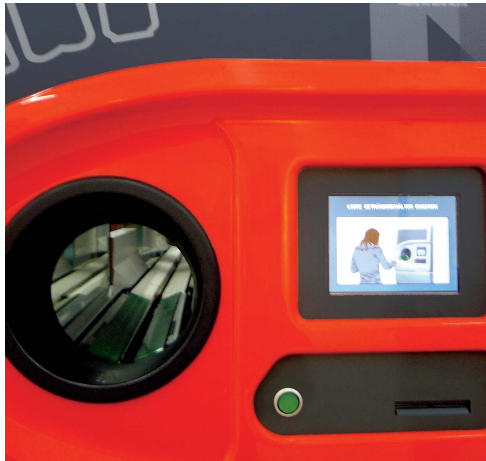
Máquina automática para devolver los envases en Alemania. A la izquierda la boca para introducir el envase, a la derecha el botón y la ranura para recoger el ticket con el importe. Foto: G. C. DEUS.
