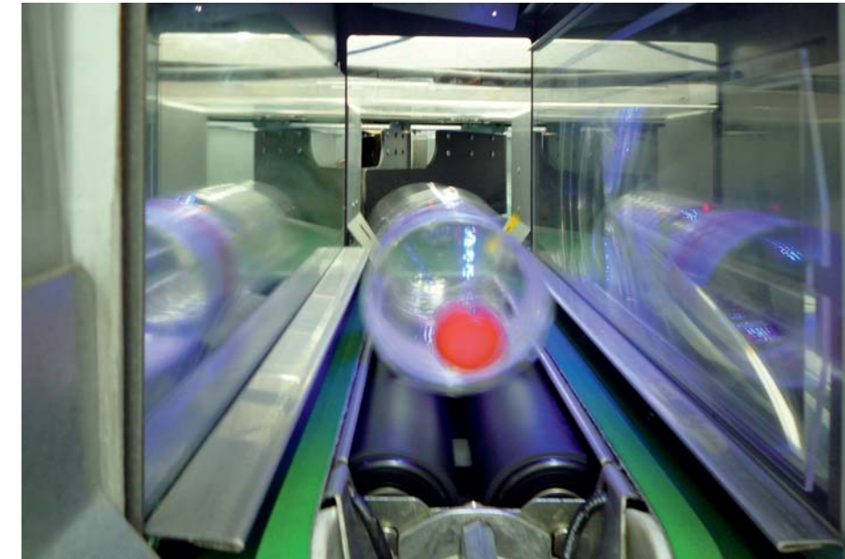
El sistema automatizado del SDDR lee, clasifica, contea e informatiza cada uno de los envases devueltos en tiempo real, para enviar a una base de datos. Foto: G. C. DEUS.
